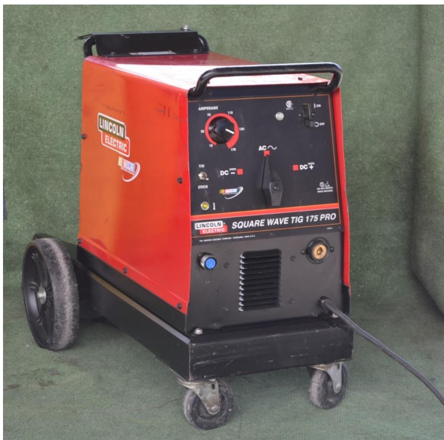
Figura 51 Equipo de soldadura eléctrica
