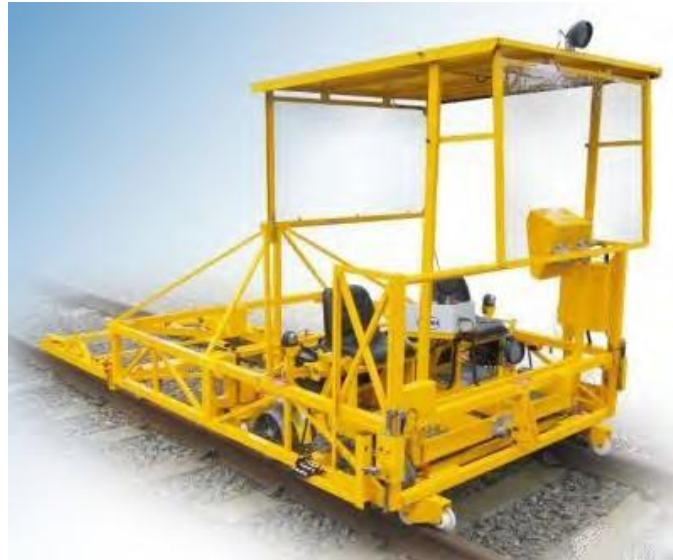
Ilustración 47 Vehículo de medición de parámetros de vía Fuente: Web
