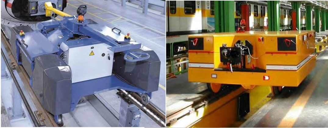
Ilustración 35 Carro de arrastre autopropulsado Fuente: Web
