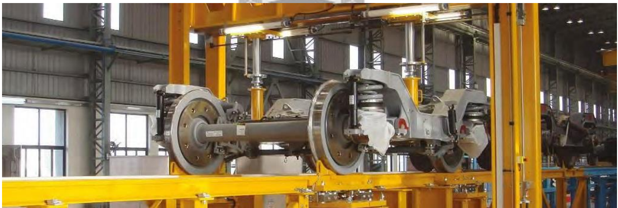
Ilustración 42 Prensa de reglaje de bogies Fuente: Web
