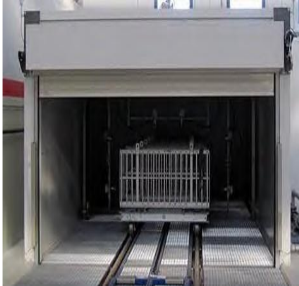
Ilustración 43 Instalación de lavado de bogíes Fuente: Web
