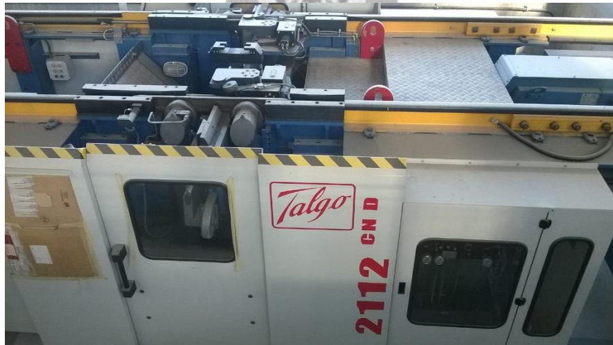
Ilustración 34 Torno de foso para ruedas Fuente: Web
