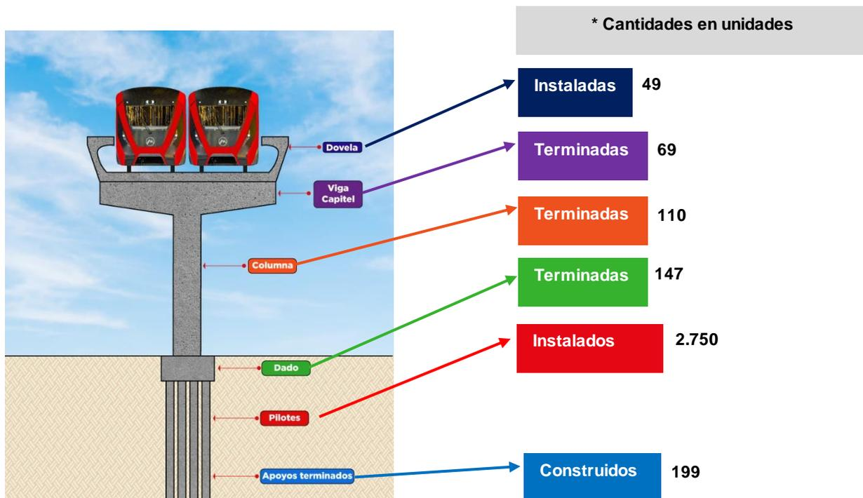
A la fecha la obra completa 199 apoyos, sobre los cuales se levantan 110 columnas que soportan 69 capiteles. En este momento hay 3 vigas lanzadoras en operación las que han instalado 49 dovelas para conformar las vigas U que soportarán el paso de los trenes.
