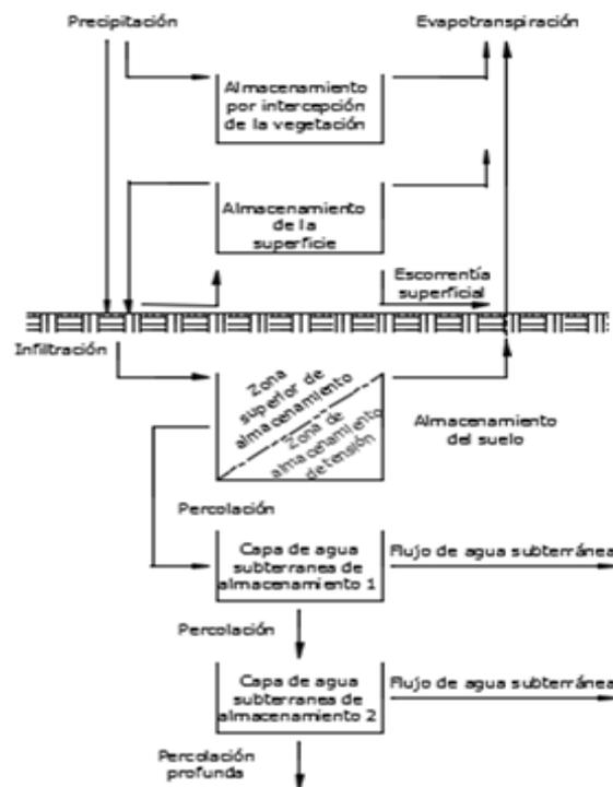
Figura 7 Esquema Conceptual del método de pérdidas del SMA
