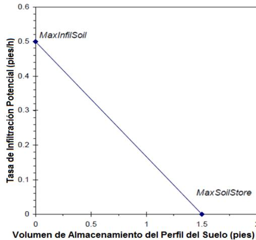
Figura 9 Relación de la Infiltración Potencial como una Función del Almacenamiento Actual en el Perfil del Suelo
