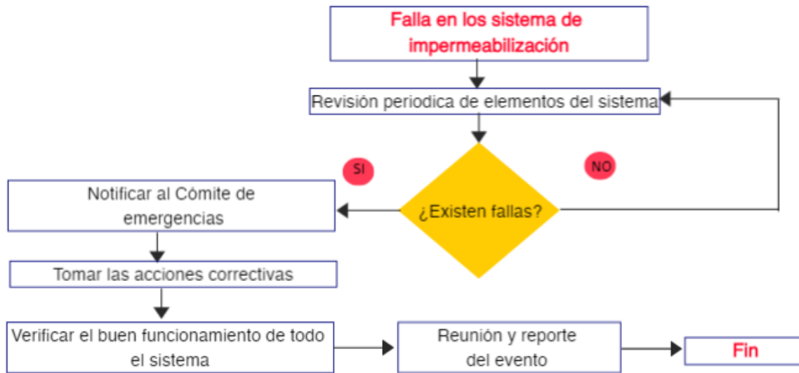
Figura 77. Procedimiento operativo para falla del sistema de impermeabilización Fuente: UT MOVIOUS, 2022
