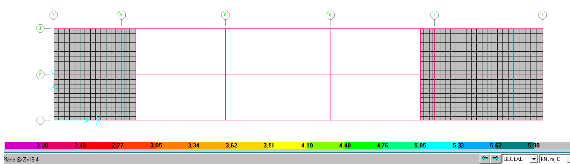
Figura 3. Planta nivel mezzanine módulo de acceso estación 17 costado occidental aplicación de la carga muerta (5,9 kN/m 2 )
