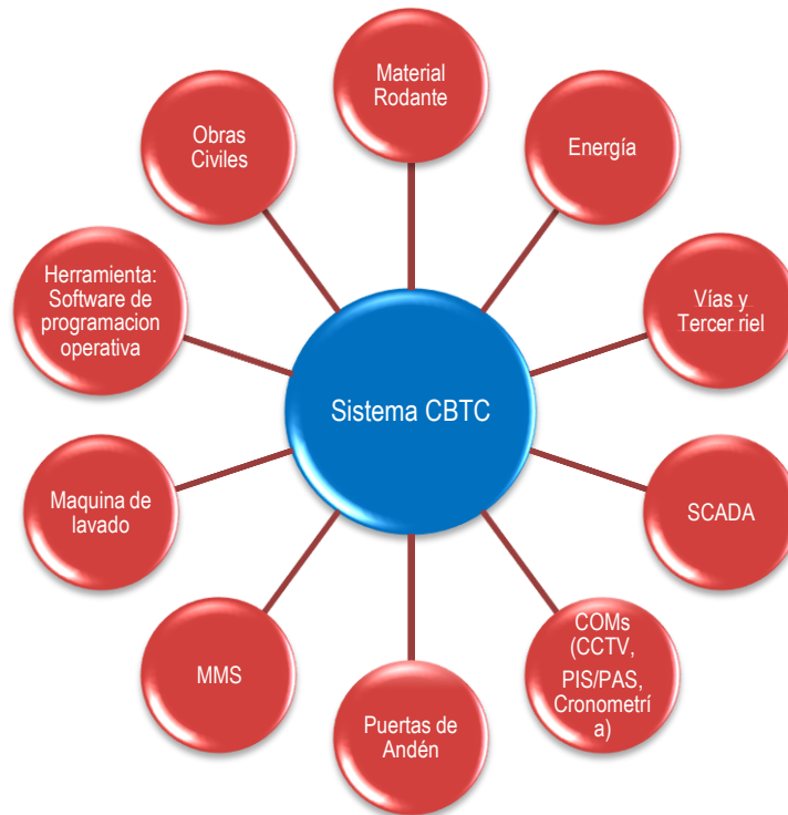
Ilustración 5. Interfaces externas del sistema de señalización CBTC
