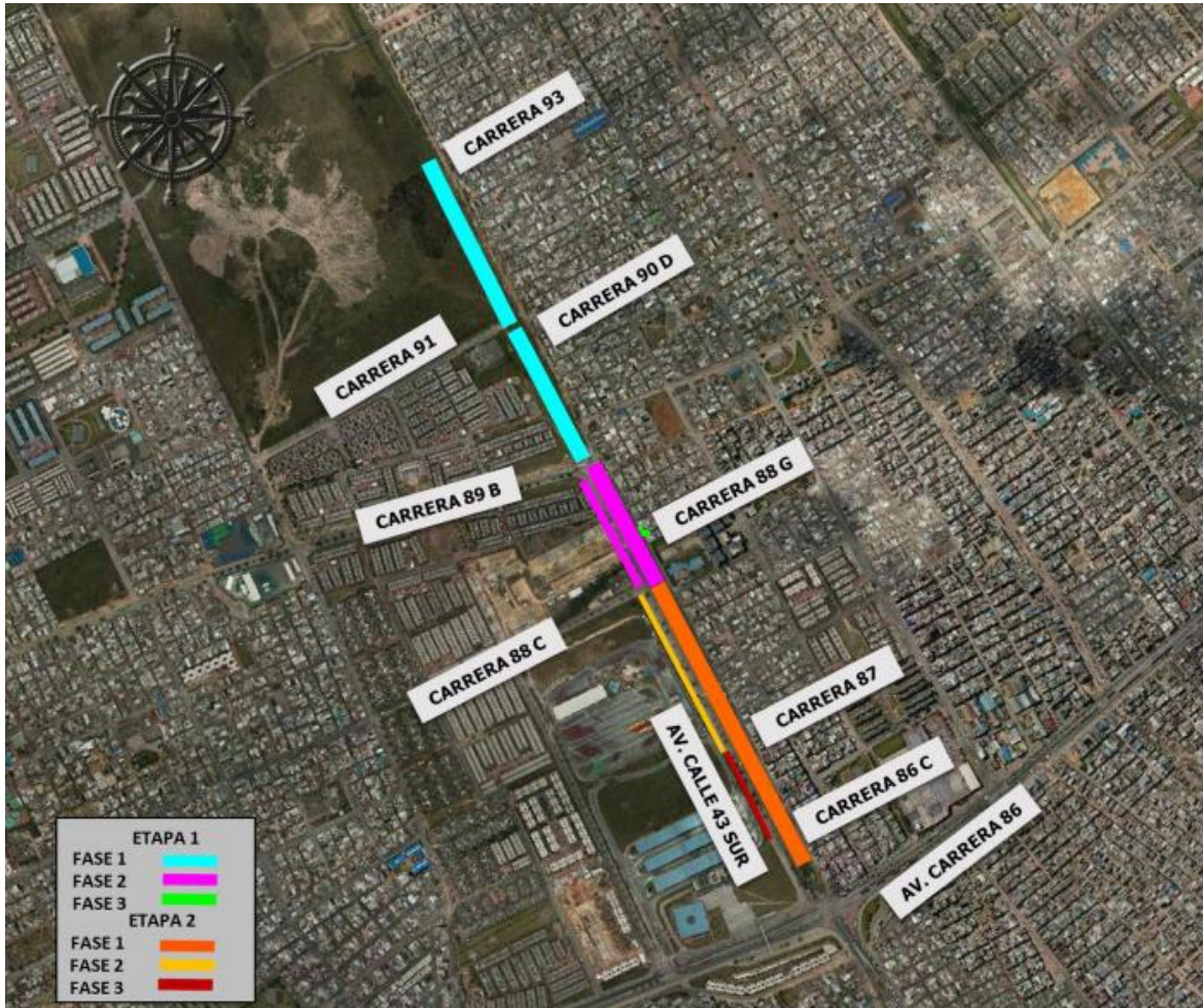
Etapas y fases del traslado de redes en el tramo 1 de la PLMB.
