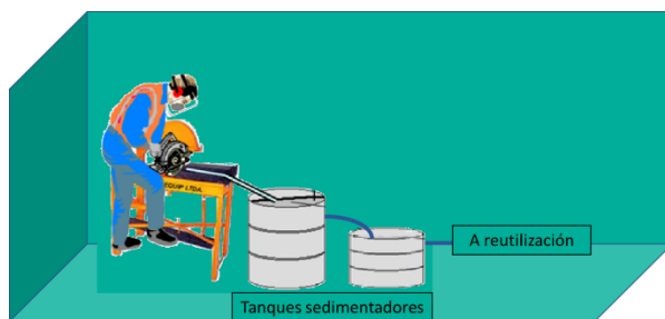
Figura 35 Esquema de corte de prefabricado en húmedo
