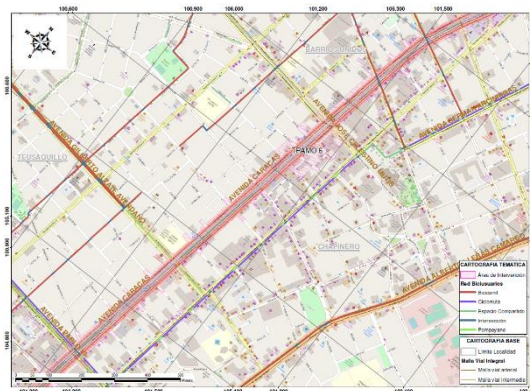
Figura 12 Intercepciones con ciclorrutas y bicarriles – Tramo 6
