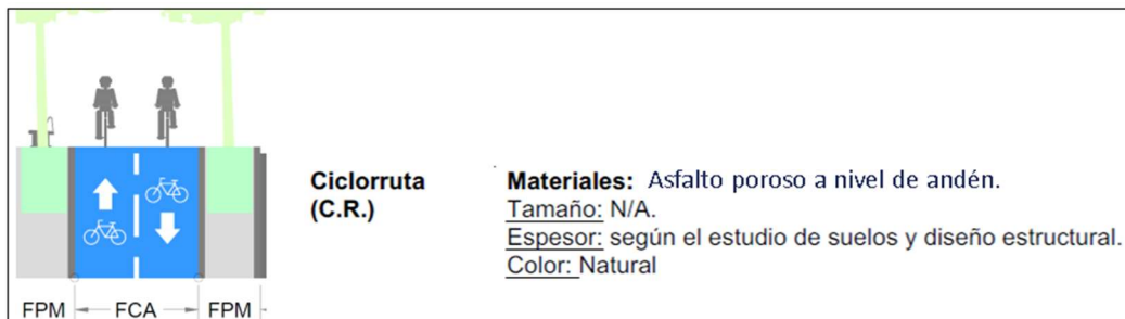
Figura 55. Criterios de diseño Franja de Ciclorruta
