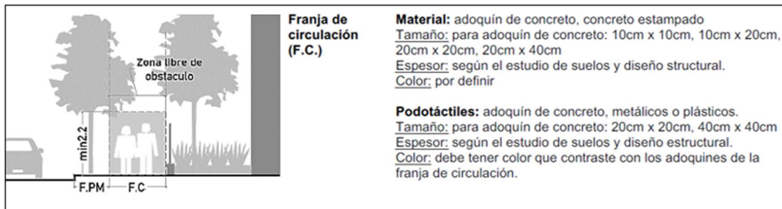
Figura 54. Criterios de diseño Franja de Circulación Peatonal
