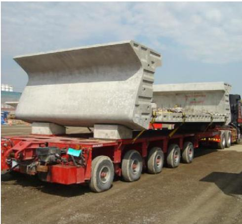
Ilustración 3.5.5-12. Transporte de dovelas del parque a obra mediante camión-remolque
