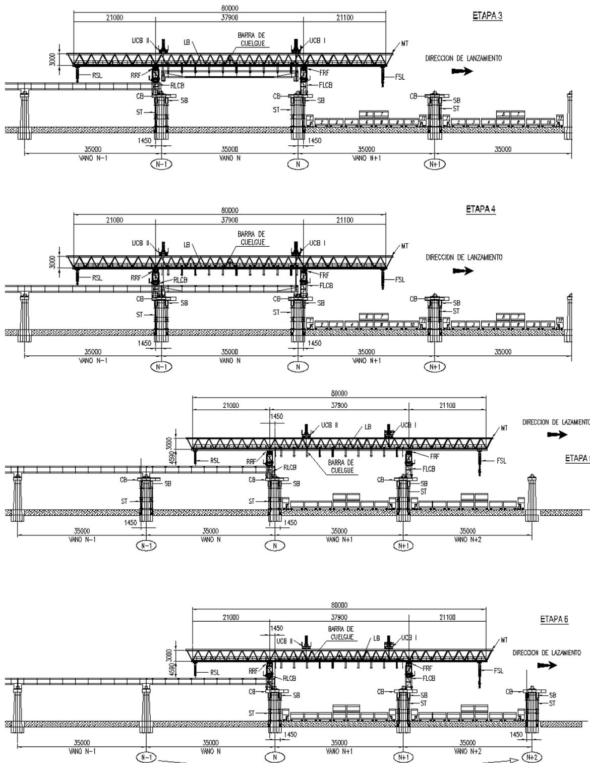
Ilustración 3.5.5-6. Fases de montaje de tramo de viaducto elevado estándar gran "U"
