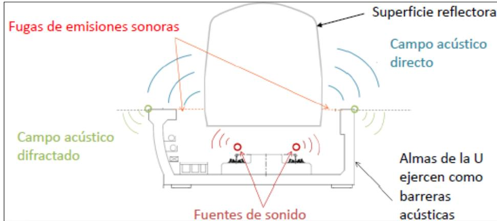
Ilustración 3.3.7-1. Emisión de ruido aéreo generado por el material rodante.
