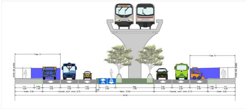
Ilustración 3.5.5-18. Sección transversal típica con afectación en Fase III
