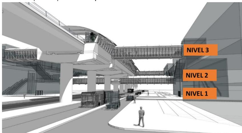
Ilustración 3.3.4-1. Configuración de estaciones. Fuente: Empresa Metro S.A.
