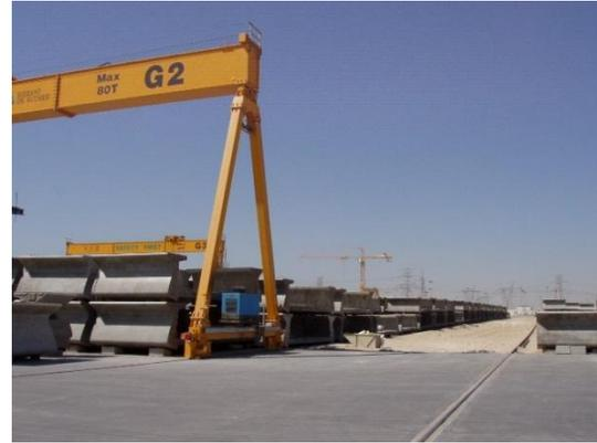
Ilustración 3.5.5-11 Doble acopio de dovelas en parque de prefabricación para metro de Dubái
