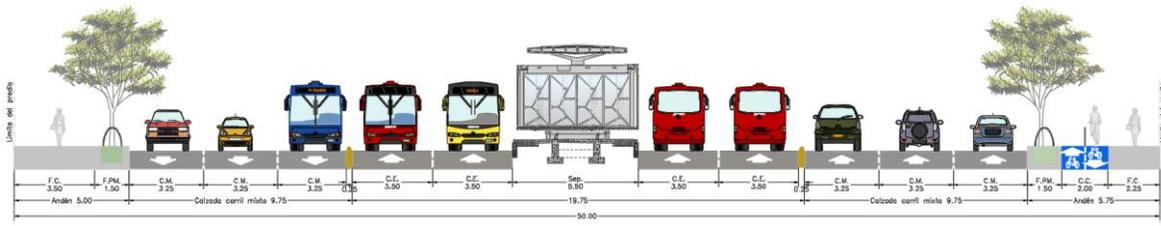
Ilustración 3.3.2-5. Sección Típica sobre la Autopista Sur entre la Av. 1 de Mayo y la CL 8 Sur.
