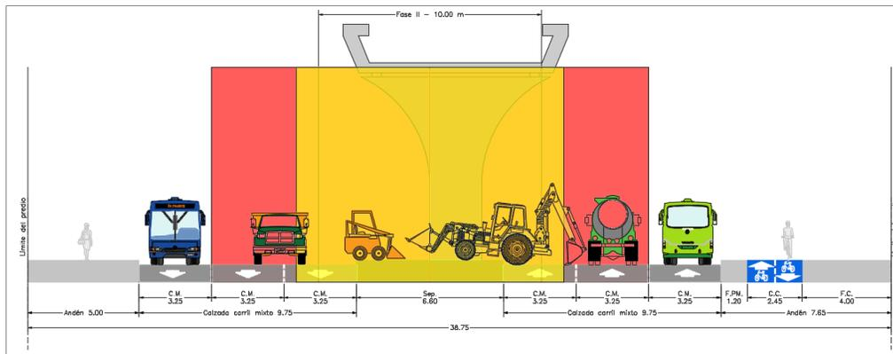
Ilustración 3.5.5-17. Sección transversal típica con afectación en Fase II
