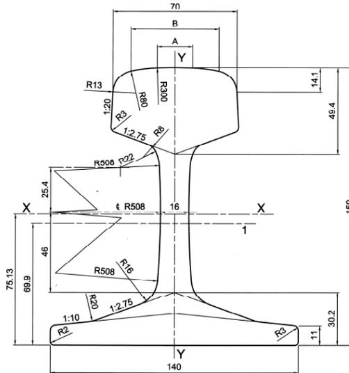
Ilustración 3.5.5-15. Perfil de riel 54E1 – extracto norma NF EN 13674-1. Fuente: Elaboración propia.
