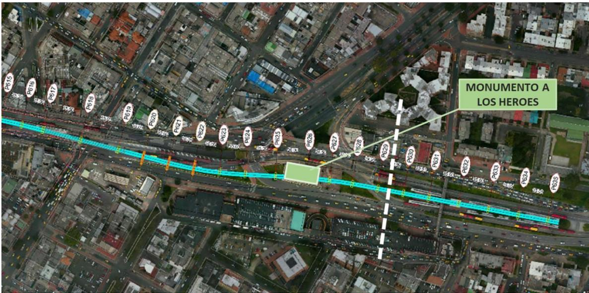
Ilustración 3.4.8-14. Trazado previsto la cola de maniobras a la altura del Monumento a los Héroes.
