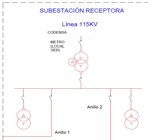
Ilustración 3.4.6-1. Diagrama típico de subestación SER. Fuente: Elaboración propia
