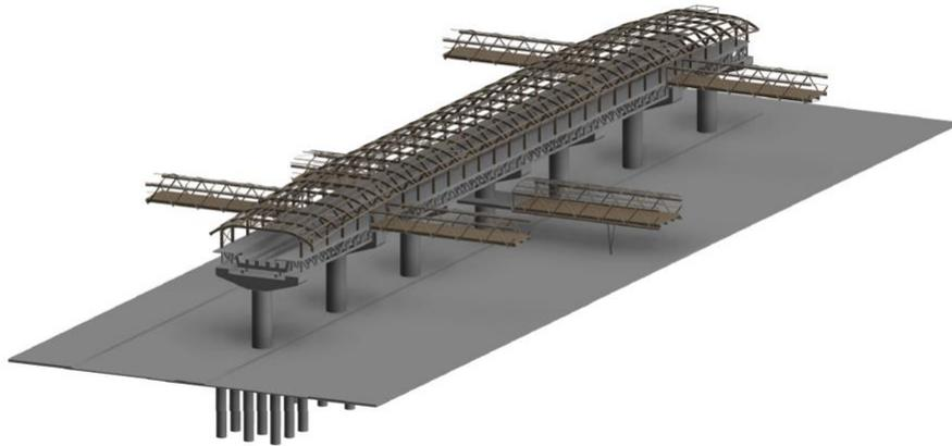
Ilustración 3.5.5-14. Estructura cuerpo central de una estación. Fuente. Elaboración Propia
